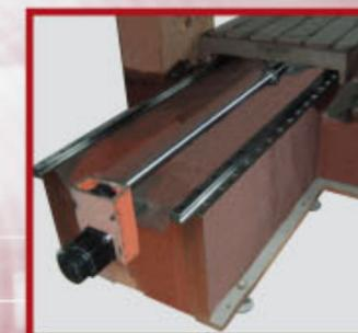
主銑頭/側面銑頭/伺服控制系統/滾珠螺桿/線性滑軌等精密零組件，均為原裝進口。
